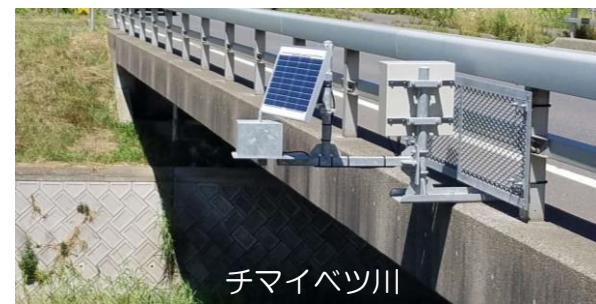
危機管理型水位計による観測データの提供（胆振総合振興局）
