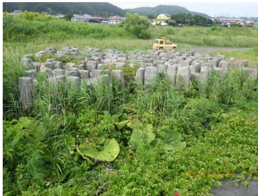
水防資材の備蓄状況（浦河出張所 元浦川根固めブロック）
