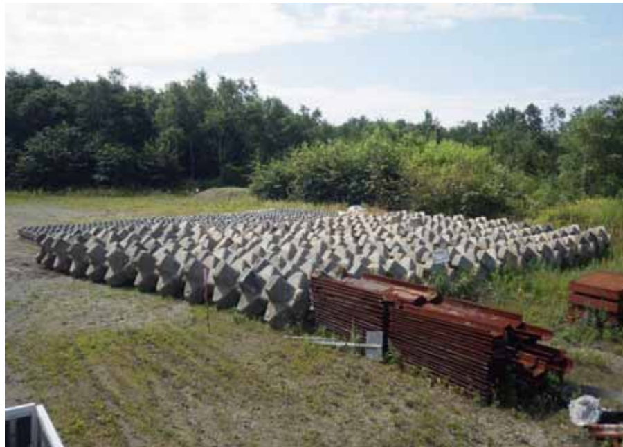
水防資材の備蓄状況（苫小牧出張所 根固めブロック）
