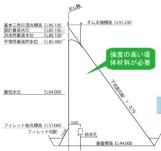
重力式コンクリートダム
