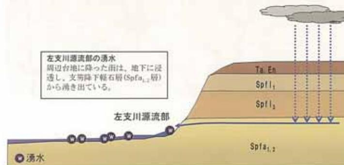
図 1.3.3 左支川源流部における湧水のしくみ
