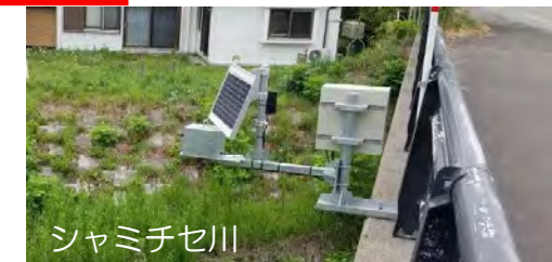
危機管理型水位計による観測データの提供（胆振総合振興局）
