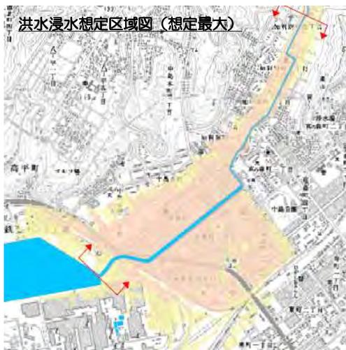
想定最大規模や計画規模のみならず、より高頻度で発生する降雨規模での洪水氾濫区域を検討する
